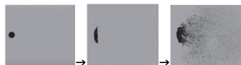
液体が高速気流中で微粒化する様子
