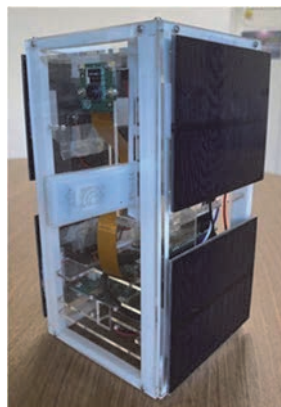
2Uサイズのキューブサット教材。メインコンピュータにRaspberry Pi Zeroを使っています
