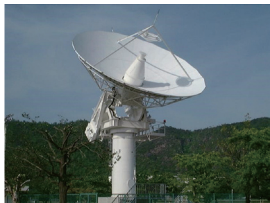
岐阜大学11m電波望遠鏡。波長1.3cm用の低雑音受信機を備え、星の周りの水蒸気やブラックホール周辺のプラズマからの電波を観測する。
