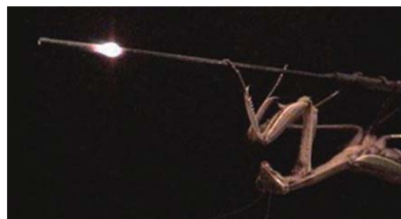
昆虫より小さいマイクロコンバスタ（微小燃焼器）
