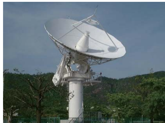
図：岐阜大学11m電波望遠鏡。波長1.3cm用の低雑音受信 機を備え、星の周りの水蒸気やブラックホール周辺の プラズマからの電波を観測する。
